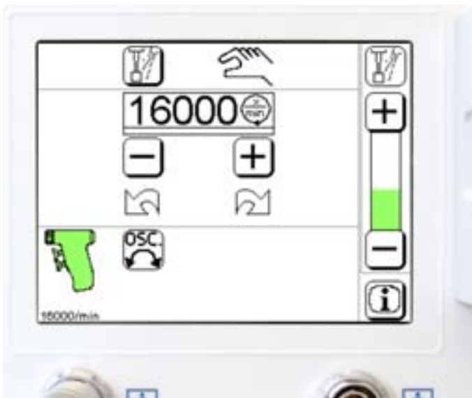
Abb. 32 Das Symbol "Anzeige für Oszillierender bzw. Gewindeschneid-Betrieb" erscheint im Motorbedienfeld.
